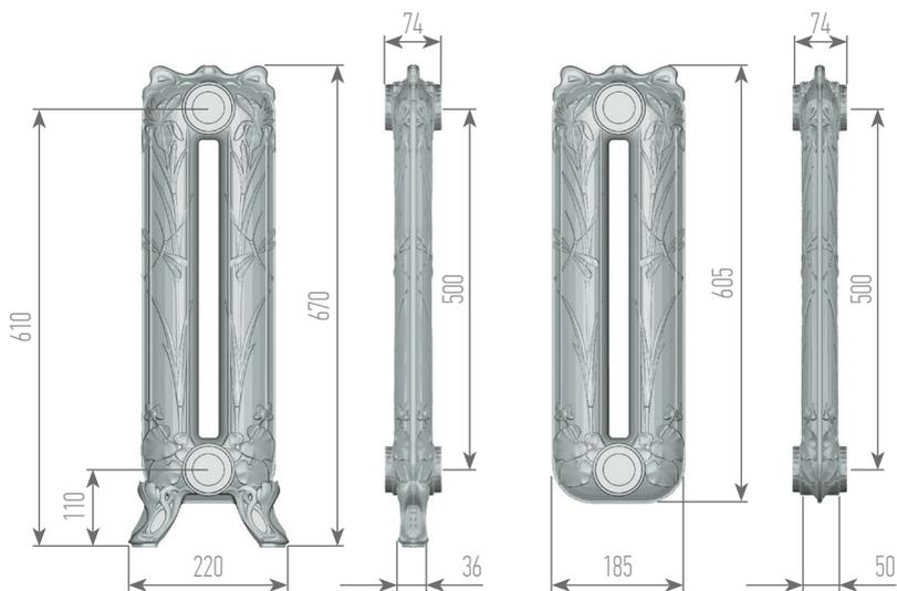
Размеры радиатора указаны без учета установленной арматуры и воздухоотводного клапана
