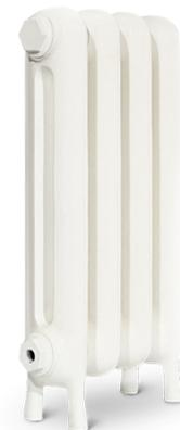
Напольные радиаторы поставляются высотой 790 мм - крайние секции с ногами и высота секции без ног 735 мм. Межцентровое расстояние при высоте радиатора 790мм составляет 640 мм. Радиатор собран из секций, соединенных друг с другом с помощью ниппельного соединения со стальной прорезиненной прокладкой. Чугунные радиаторы имеют вход/выход на 1/2" или 3/4", отверстие под кран Маевского на 1/2" или 3/4".
