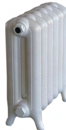
Напольные радиаторы поставляются высотой 550 мм - крайние секции с ногами и высота секции без ног 500 мм. Межцентровое расстояние при высоте радиатора 550 мм составляет 400 мм. Радиатор собран из секций, соединенных друг с другом с помощью ниппельного соединения со стальной прорезиненной прокладкой. Чугунные радиаторы имеют вход/выход на 1/2" или 3/4", отверстие под кран Маевского на 1/2" или 3/4".
